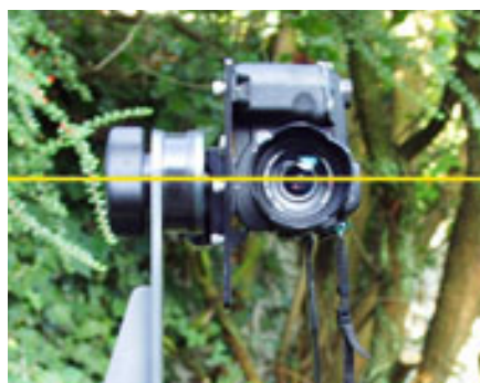
Le centre de l'optique et l'axe de basculement de la rotule se trouvent sur une même ligne horizontale.
