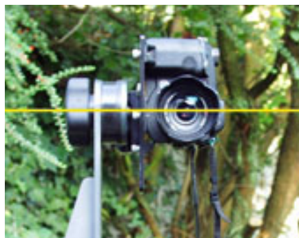
Le centre de l'optique et l'axe de basculement de la rotule se trouvent sur une même ligne horizontale.
